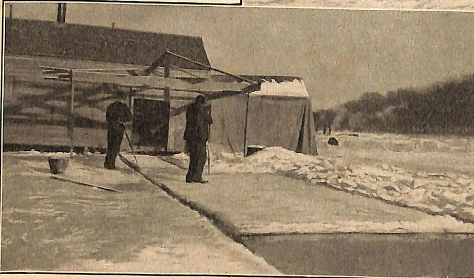
Après le balayage on trace à l'aide d'une sorte de scie des rectangles d'un mètre de long sur 0 m. 60 de large.
